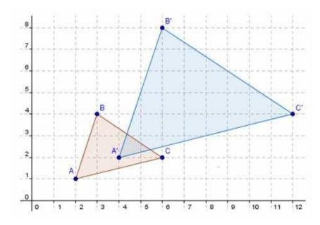
$$S_v p = egin{bmatrix} v_x & 0 & 0 \ 0 & v_y & 0 \ 0 & 0 & v_z \end{bmatrix} egin{bmatrix} p_x \ p_y \ p_z \end{bmatrix} = egin{bmatrix} v_x p_x \ v_y p_y \ v_z p_z \end{bmatrix}$$
